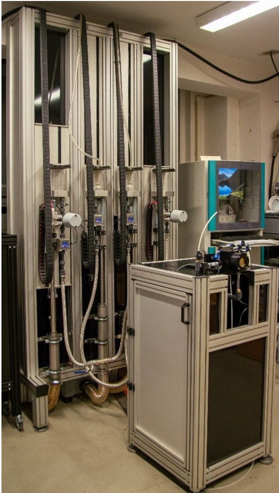
Abbildung 2: Prüfstand zur Untersuchung von Herzunterstützungssystemen am Fachgebiet Fluidsystemdynamik
