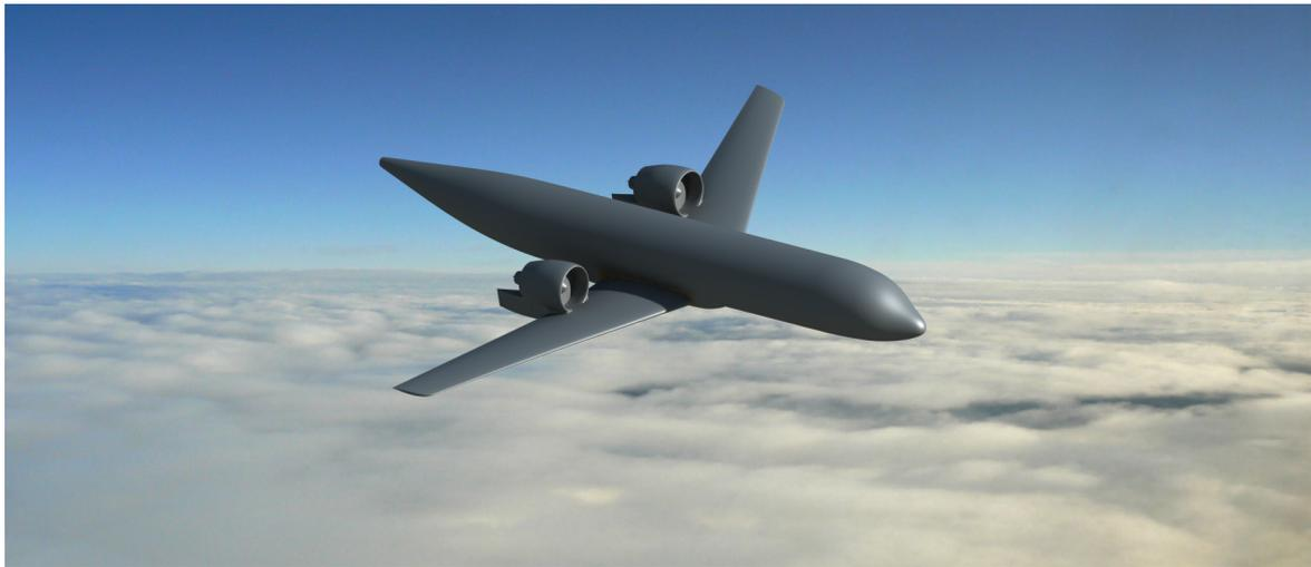
**Abbildung 3:** Flugzeugmodell (ohne Leitwerke) mit eingebetteten Triebwerken
