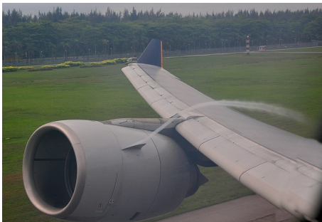
Abbildung 1: Längswirbel am Gondelstrake eines Verkehrsflugzeuges, [1]
