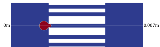
Abbildung 1: Tropfen in idealisierter poröser Struktur mit parallelen Kanälen. Der weiße Strich von 0 bis 0.007 m zeigt das Druckprofil in Abbildung 2
